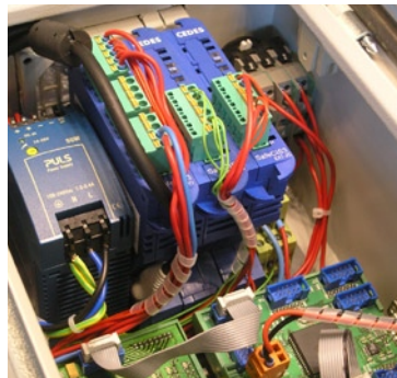
...und passt in jeden Schaltschrank. (abgebildet mit zwei Erweiterungsmodulen) mit bis zu 14 Ausgängen.
